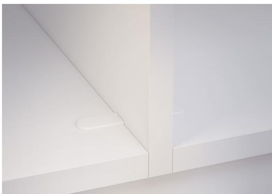
La giunzione viene inserita nel pezzo orizzontale durante la fresatura. Questa operazione può avvenire prima del trasporto in produzione o dopo il trasporto nel luogo di destinazione. In seguito la vite premontata nella giunzione viene avvitata con un cacciavite a sfera nella foratura di 5 mm del contropezzo. Grazie all'avvitatore a batteria i pezzi vengono congiunti in modo rapido e resistente
